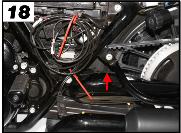
Platzieren Sie die Remus Steuereinheit wie abgebildet. Stecken Sie die Kabel des Tasters und der Aktuatoren an die REMUS Steuereinheit an und verbinden diese mit dem Diagnosestecker. Anschließend montieren Sie wieder den Tank (Abb.19/20).
