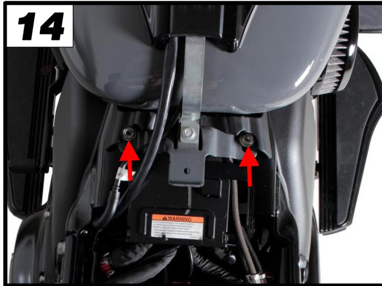
Montieren Sie den REMUS Taster und verlegen Sie das Kabel im Kabelkanal (Abb.15/16).
