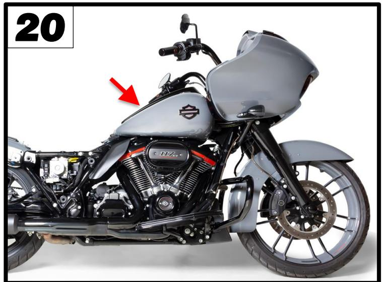
Befestigen Sie die vorderen und hinteren Schrauben des Benzintanks (Abb.21/22).
