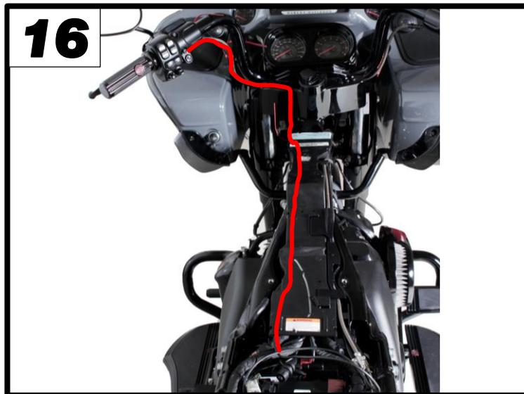
Verlegen Sie das REMUS Aktuatorkabel vom rechten und linken Schalldämpfer und befestigen Sie dieses mit Kabelbinder (Abb.17/18) .
